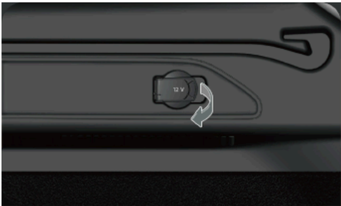
Задний интерфейс питания 12 В * расположен на правой стороне заднего багажника, и к нему можно получить доступ, открыв накладку.
