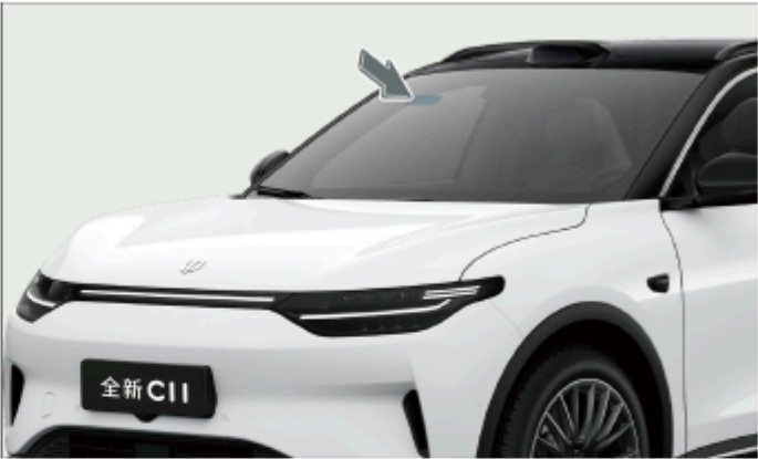
Для обеспечения установки и считывания электронная табличка транспортного средства, окно для микроволнового радара зарезервировано с правой стороны переднего лобового стекла транспортного средства.
