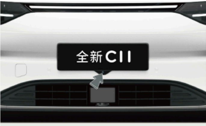
Камера переднего обзора установлена под номерным знаком для съемки передней части автомобиля.
