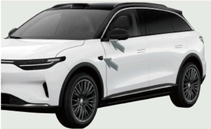
Четыре камеры наблюдения за слепыми зонами, две расположены над левым и правым крыльями автомобиля; две на левом и правом наружных зеркалах заднего вида.
