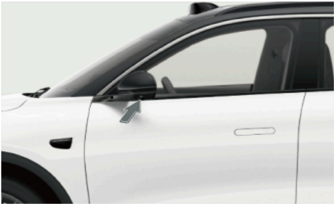
Левая и правая камеры установлены в нижней части левого и правого зеркал заднего вида для съемки боковой части автомобиля.
