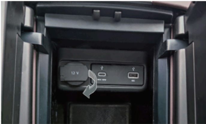
Передний интерфейс питания 12 В расположен в заднем центральном ящике для хранения, и к нему можно получить доступ, открыв накладную крышку.
