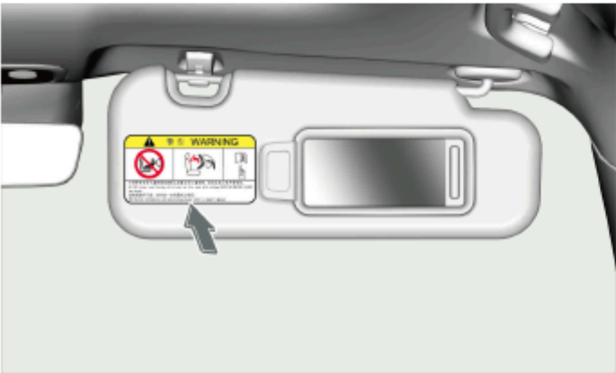
Предупреждающие надписи о подушках безопасности наклеены спереди солнцезащитного козырька со стороны пассажира, один спереди солнцезащитного козырька, а другой сзади солнцезащитного козырька.
