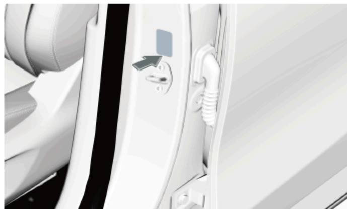
Табличка с указанием давления в шинах наклеена на внешнюю панель левой стойки В.
